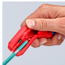
Abmanteln eines Datenkabels
