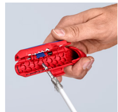
Abisolieren eines Koaxialkabels
