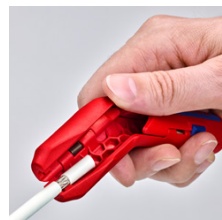
Abmanteln eines Koaxialkabels
