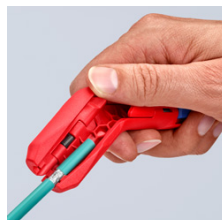
Abmanteln eines Datenkabels
