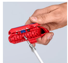
Abisolieren eines Koaxialkabels
