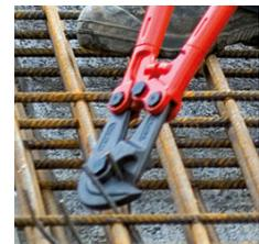
Die besondere Kopfform des Mattenschneiders 71 82 950 ermöglicht das Schneiden flachliegender Baustähle
