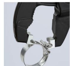
Schließen einer Schlauchschelle mit Anschlag
