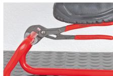
Gegen die Drehrichtung versetzte Zähne bewirken einen Selbstklemmeffekt und verhindern das Abrutschen am Werkstück.
