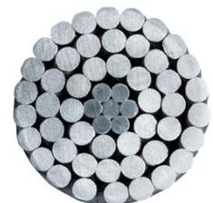
Der äußere Bereich dieser Freileitungsseile besteht aus leichten, hochleitfähigen Aluminiumdrähten, der Kern aus besonders dehnungsfesten verzinkten Stahldrähten
