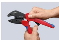
Wechselposition: Ausklappen des Servicehebels für parallele Backenstellung
