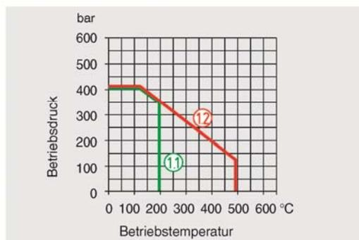
Alle Drehverschraubungen mit PTFE-Dichtung:
