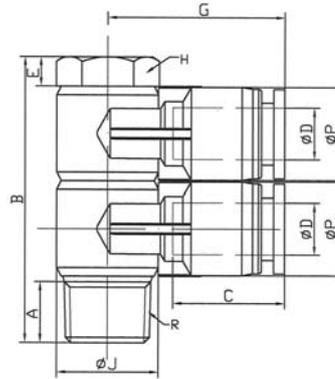
**L-Mehrfachverteiler mit Außensechskant, 4-fach, drehbar, Außengewinde konisch mit Gewindebeschichtung**
