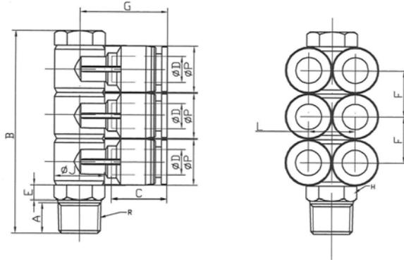
**L-Mehrfachverteiler mit Außensechskant, 6-fach, drehbar, Außengewinde zylindrisch mit O-Ring (NBR)**
