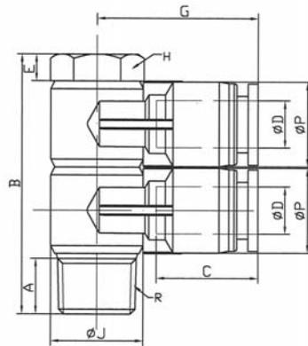
**L-Mehrfachverteiler mit Außensechskant, 4-fach, drehbar, Außengewinde zylindrisch mit O-Ring (NBR)**
