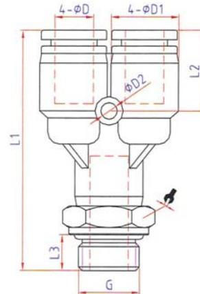
**Mehrfachverteiler mit Außengewinde, 4-fach, drehbar, Außengewinde konisch mit Gewindebeschichtung**
