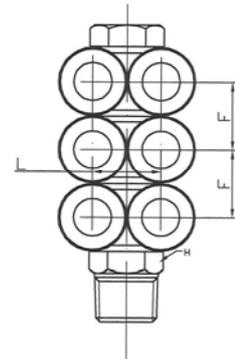
**L-Mehrfachverteiler mit Außensechskant, 6-fach, drehbar, Außengewinde konisch mit Gewindebeschichtung**
