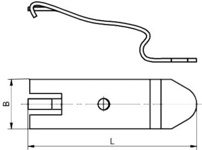
**Befestigungssatz (Schiene) für Grundejektoren**
