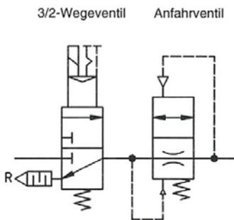
Belüftung der Anlage über Drosselstellung des Anfahrventils.
