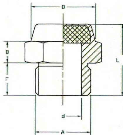
**Schalldämpfer aus Sinterbronze**, mit Messing-Sechskant und Messing-Gewinde
