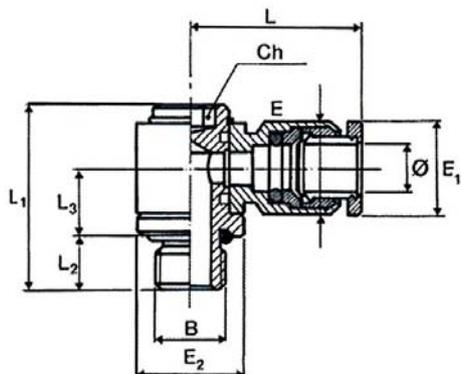
**Schwenkverschraubung**, drehbar, Außengewinde zylindrisch mit O-Ring
