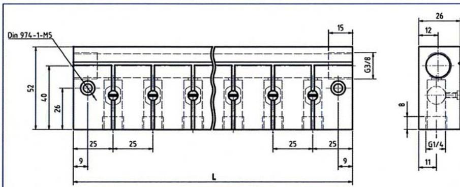
Dient als Verteiler- und Absperrleiste in komplexen Maschinen und Anlagen, bei denen es notwendig ist einzelne Steuerkreise abzuschalten.
