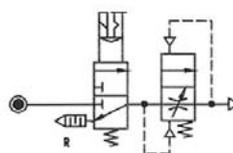
Belüftung der Anlage über Drosselstellung des Anfahrventils.
