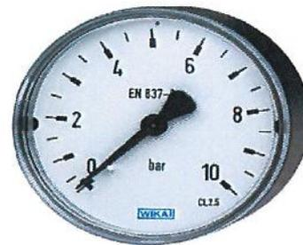
Druckmessgerät mit Rohrfeder Typ 111.12
