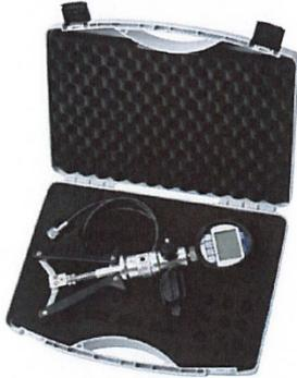
Kalibrierkoffer mit Digitalmanometer Typ CPG500 und Handprüfpumpe Typ CPP40 für die Messgröße Druck, -0,95 ... +40 bar bestehend aus:
