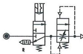
Belüftung der Anlage über Drosselstellung des Anfahrventils.
