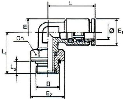
**Winkel-Einschraubverschraubung**, drehbar, Außengewinde zylindrisch mit O-Ring
