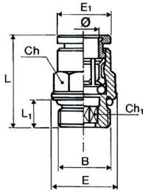
Gerade Einschraubverschraubung, mit zylindrischem Außengewinde und O-Ring
