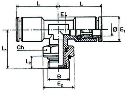
**T-Einschraubverschraubung**, drehbar, Außengewinde zylindrisch mit O-Ring
