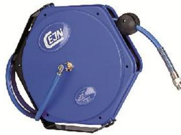
zur einfachen Wand- und Deckenmontage. Schlagfestes, solides und geschlossenes Gehäuse aus POM (Acetatkunststoff), mit R 1/4 AG und leichtem, strapazierfähigem und ölbeständigem Polyurethanschlauch. Inkl. 2 m Zuleitungsschlauch.
