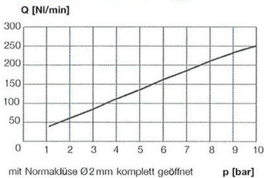
Blaspistole mit Standarddüse, Bohrung 2,0 mm (Gewinde M12x1,25)
