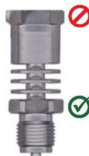
Montage d'un élément de refroidissement
