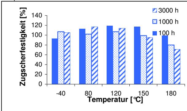
Zugscherfestigkeit Al/Al sandgestrahlt bei Temperatur bezogen auf Wert bei Raumtemperatur gemessen bei angegebener Temperatur entsprechend DIN EN 1465
