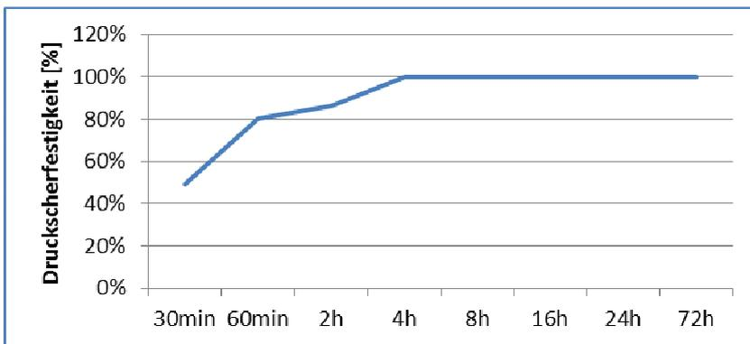
Druckscherfestigkeit Welle/Nabe mit Aktivator DELO-QUICK 5006
