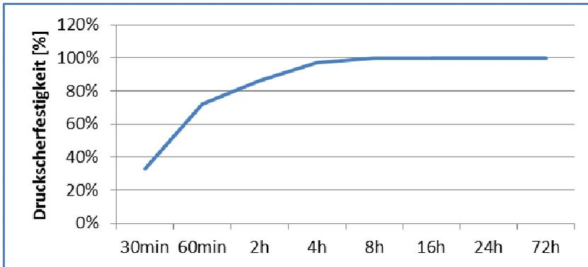
Druckscherfestigkeit Welle/Nabe mit Aktivator DELO-QUICK 5006
