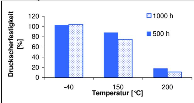
Druckscherfestigkeit Welle/Nabe bei Temperatur bezogen auf Wert bei Raumtemperatur gemessen bei angegebener Temperatur in Anlehnung an ISO 10123
