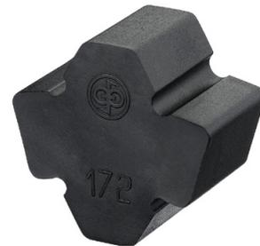
Die Pakete der N-EUPEX DS Baureihe werden druck- und biegebeansprucht. Bei Zerstörung der Pakete drehen sich die Metallteile ohne Kontakt gegeneinander, die Kraftübertragung ist getrennt. Durch den Einbau neuer Pakete ist die Kupplung wieder verwendungsfähig. Die überlastwerfende Eigenschaft der N-EUPEX DS Baureihe wird, z. B. bei besonders empfindlichen Maschinen gefordert.
