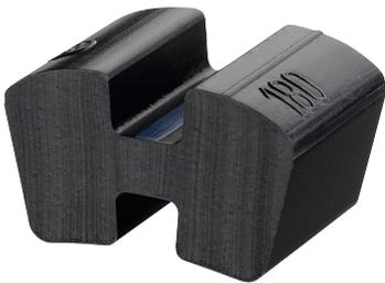
Die Pakete der N-EUPEX Kupplung werden druckbeansprucht. Bei Zerstörung der Pakete findet Metallkontakt der Nabenteile statt. Diese "Notlaufefigenschaft" wird z. B. bei Feuerlöschpumpen gefordert.
