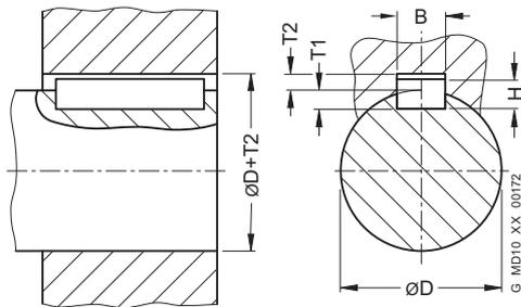
Für moderate Betriebsbedingungen wird die Nabennuttoleranz JS9 empfohlen.
