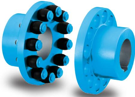
RUPEX Bolzenkupplungen verbinden Maschinenwellen und gleichen Wellenversatz bei geringen Rückstellkräften aus. Das Drehmoment wird über Elastomerpuffer geleitet, damit besitzt die Kupplung die typisch gummielastischen Eigenschaften.
