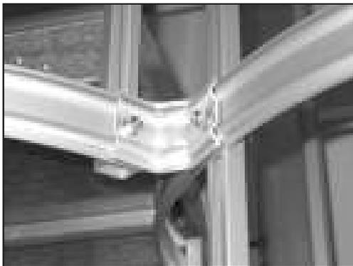
Jede „offene“ Rückenschutzstrebe mit einer Kunststoffendkappe verschlossen werden (Verletzungsgefahr).
