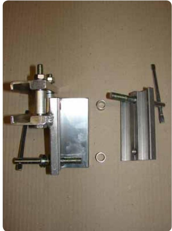
Knebeleinrichtung von oben auf den Querholm aufsetzen. Klemmschale von unten auf die Sechskantschrauben aufschieben. U-Scheiben und Sechskantmuttern auf die Schraubenenden aufschrauben.
