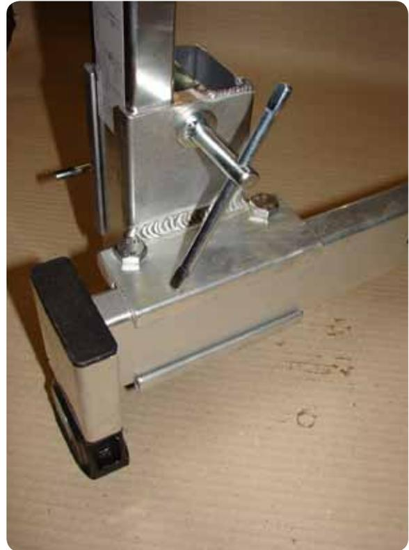
Knebelschrauben öffnen und Holmverlängerung in die Klemmschalen einschieben. Knebelschrauben festziehen.
