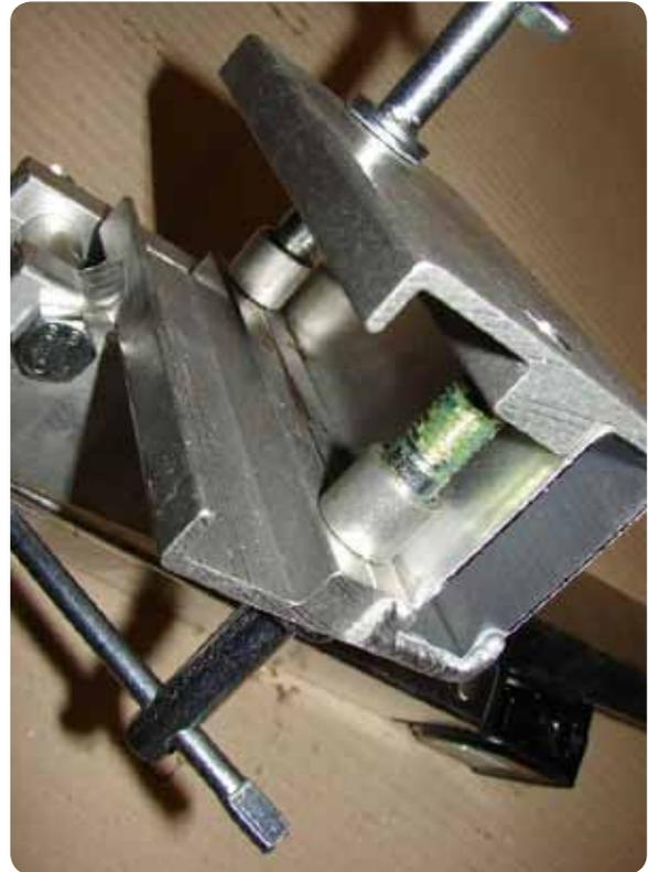
Klemmeinrichtung möglichst weit nach außen schieben. Sechskantmuttern festziehen. Knebelschrauben öffnen und Holmverlängerung in die Klemmschalen einschieben. Knebelschrauben festziehen.
