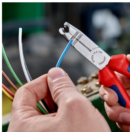
Abisolierlöcher für Leiter 1,5 und 2,5 mm 2
