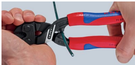
mit Greiffläche unter dem Gelenk zum Greifen und Ziehen von Drähten ab Ø 1,0 mm
