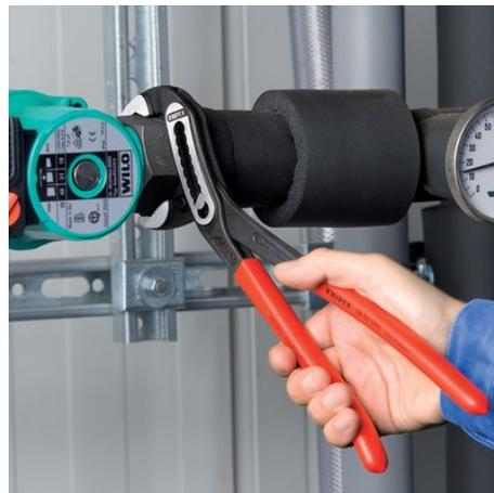
Selbstklemmend an Röhren und Muttern: kein Abrutschen am Werkstück; die gesamte Betätigungskraft kann zum Drehen der Werkstücke eingesetzt werden; festes Zusammendrücken der Zangenschenkel ist nicht erforderlich, dadurch weniger Kraftaufwand
