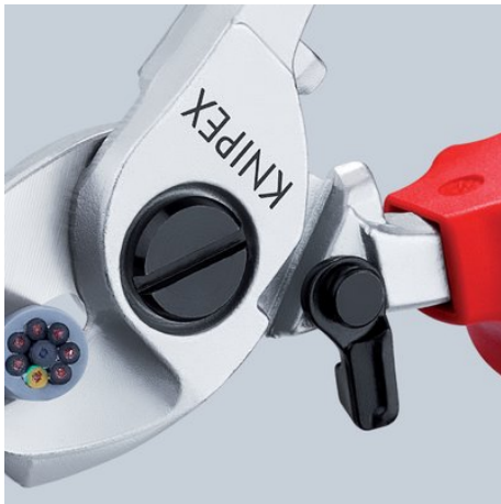
95 26 165: Sperrklinke verriegelt Scheren mit innenliegender Öffnungsfeder
