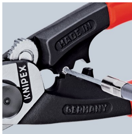
Anpressen der Endkappe an das Zugseil
