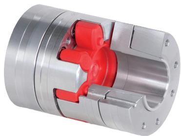
Bei der ROTEX® GS handelt es sich um eine dreiteilige, unter Vorspannung spielfreie, axial steckbare Kupplung. Sie überzeugt selbst in kritischen Applikationen durch spielfreie Drehmomentübertragung, dem jeweiligen Einsatz ideal angepasster Steifigkeit und optimaler Schwingungsdämpfung. Bei der Verwendung dieses Prinzips ergeben sich besonders montagefreundliche und fertigungsoptimierte Einbaumöglichkeiten.
