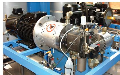
Wartungsfreie Abdichtung von Dosierpumpen für Polyol und Isocyanat in Hochdruck-Reaktionsgießmaschinen
