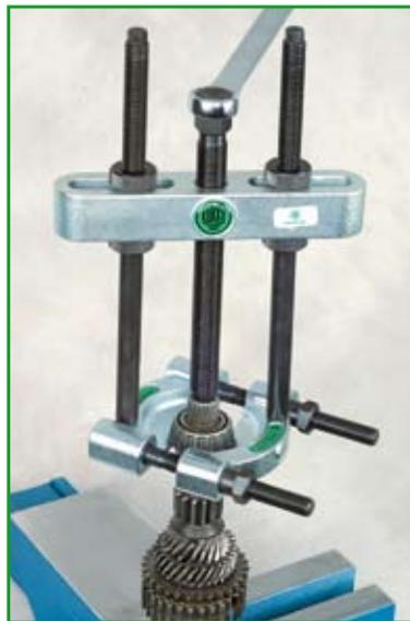
Das Abziehen erfolgt durch Anziehen der Spindel gegen das Wellenende.
