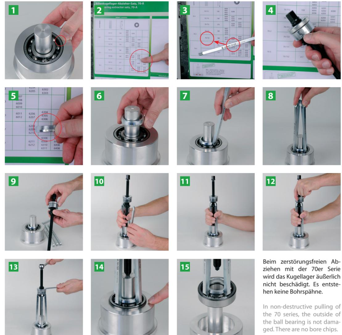
Beim zerstörungsfreien Abziehen mit der 70er Serie wird das Kugellager äußerlich nicht beschädigt. Es entstehen keine Bohrspähne.
