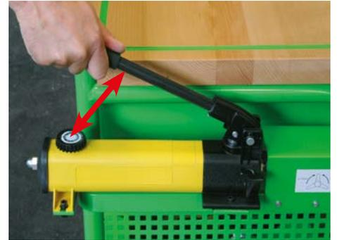
Durch Betätigen der Handpumpe wird die Abziehvorrichtung auf die erforderliche Höhe gebracht.
