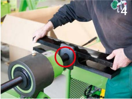
Montage der Traverse am Hydraulikzylinder. Schieben Sie die Traverse über die Spindel an den Hydraulikzylinder. Befestigen Sie die Traverse mithilfe der zwei mitgelieferten Zylinderschrauben am Zylinder.
