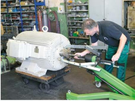
Die Spindel muss mit Hilfe der Handkurbel zentriert und handfest vorgespannt werden.
