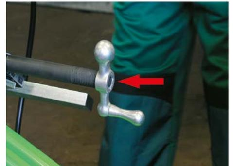
Die Handkurbel wird auf den Vierkant der Spindel gesteckt. Dann wird die Spindel mit der Handkurbel zentriert und handfest vorgespannt.
