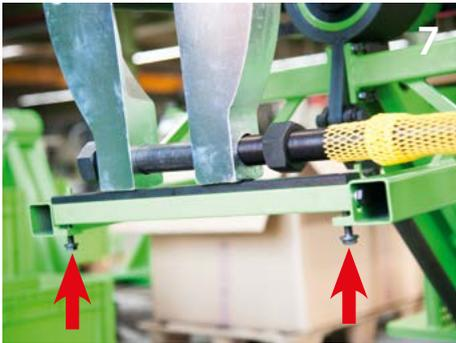
Stützleiste so einstellen, dass das Trennmesser aufliegt und in Waage ist. Jetzt die Klemmschrauben anziehen.
