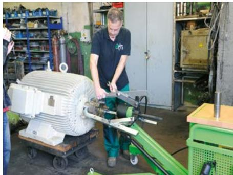
Die Abzughaken an das abzuziehende Teil anlegen und mit einem Schraubenschlüssel festziehen. Auf den richtigen Sitz und ein gleichmäßiges Anliegen der Haken achten!
