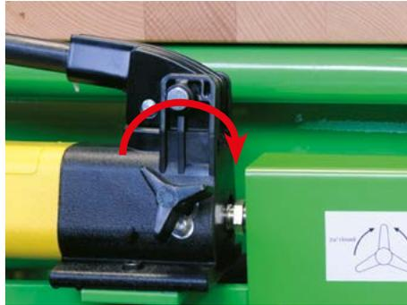
Das Absperrventil muss vor Betätigung der Handpumpe geschlossen werden.
