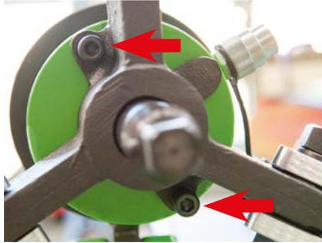
Lösen Sie die zwei Zylinder an der Traverse.
