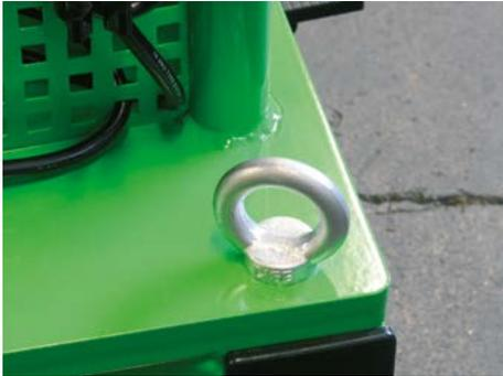
Durch die vorhandenen Aufhängungsösen kann der Abzieher mit Hilfe von Kransystemen bewegt werden.
