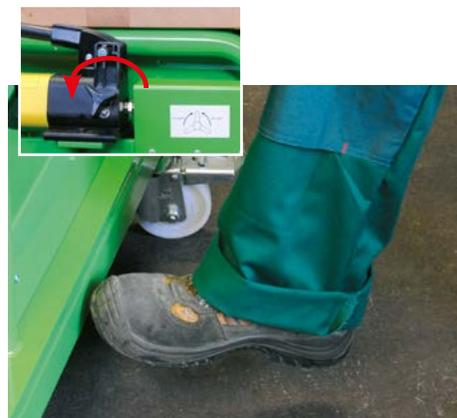
Das Fußpedal treten und dabei gleichzeitig das Absperrventil der Handpumpe öffnen.
