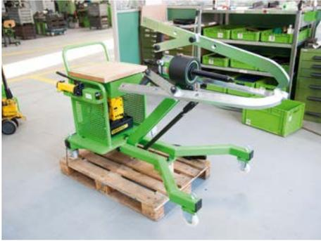
Abzieher / Hydraulikzylinder mithilfe der Handpumpe auf eine angenehme Arbeitshöhe bringen.
