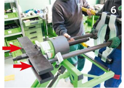
Zu zweit das Trennmesser in die Traverse einsetzen und von hinten befestigen. Setzen Sie das Trennmesser in die Traverse ein. **Achtung!** Führen Sie diese Arbeit zu zweit aus.
