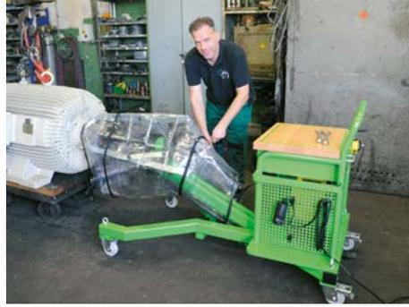
Die Abziehvorrichtung komplett mit Schutzplane (UFP-3) umhüllen.
