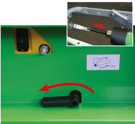
Nach Beendigung des Abziehvorgangs das Absperrventil in Position „Auf“ bringen. Die Spindel fährt automatisch zurück.
