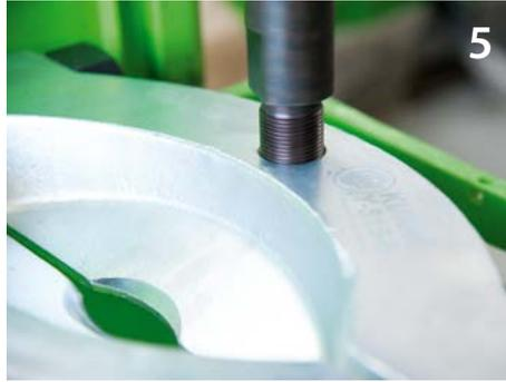
Montieren Sie das Trennmesser vor. **Wichtig:** Zugbolzen bis zum Anschlag einschrauben.
