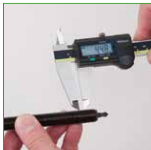
c Messen Sie die Länge über 3 Gewindegänge. Measure the length over three turns of the thread.
