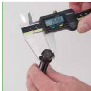
d Messen Sie den Sechskant des Spindelkopfes. Measure the hexagon of the spindle head.
