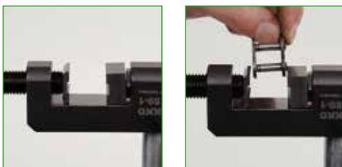
Wenn ein Kettenschloss montiert werden soll, sind die beiden Druckplatten zu verwenden. Die Führung der Abschlussplatte wird dabei in die Spannschraube gesteckt und der Druckadapter auf den Vernietungsbolzen. Nachdem die Seitenplatte des Kettenschlosses positioniert ist, wird dieses mit Hilfe des Druckadapters durch Drehen der Druckspindel aufgedrückt.
