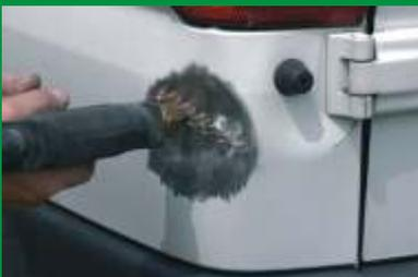
Das Anpunkten des Wellendrahtes soll dem Konturverlauf entsprechend, im Bereich der tiefsten Eindellung erfolgen. Der Wellendraht ist Garant für problemloses, großflächiges Rückverformen, an mit konventionellen Ausbeulpraktiken nicht erreichbaren Karosseriebereichen.
