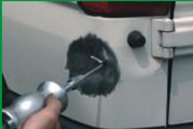
Zughaken in U-Scheibe einhängen und mittels Schlagauszieher rückverformen.
