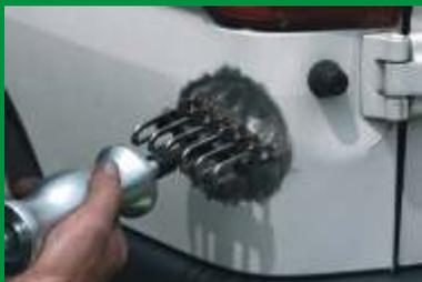
Je nach Schadensumfang entsprechende Ausziehkrallen in Wellendraht einhängen und mit Schlagauszieher rückverformen.
