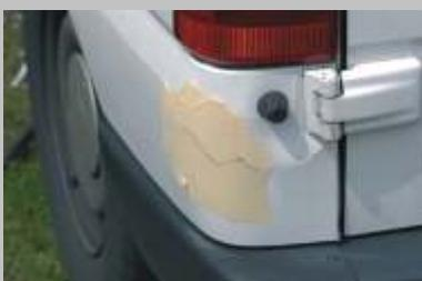
Restliche Unebenheiten werden verzinkt oder mit Spachtelmasse ausgeglichen.
