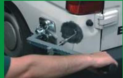
Zughaken und Schnellausbeulheber in Kombination ermöglichen ein besonders gefühllvolles Rückverformen.
