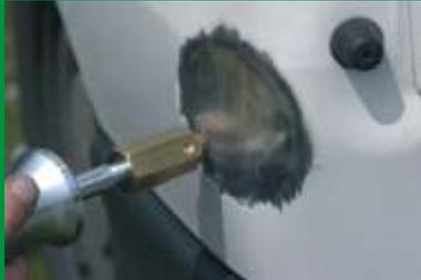
Auch mittels einer Anschweißplatte und Zugklemme ist ein sehr wirkungsvolles Ausbeulen möglich.
