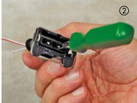
② Werkzeug bis zum Anschlag in Richtung des Kontakts drücken, der Kontakt entriegelt "spürbar".
