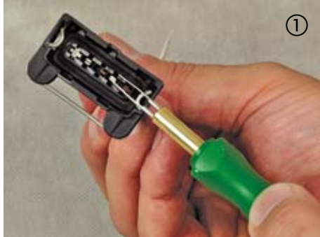
① Werkzeug in die Entriegelungskanäle einführen.
