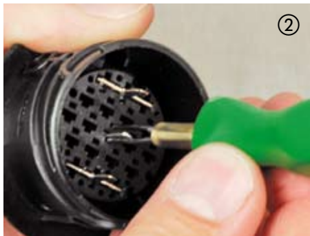
② Werkzeug bis zum Anschlag in Richtung des Kontakts drücken, der Kontakt entriegelt "spürbar".
