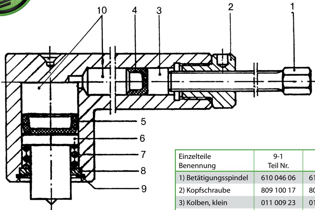
Die Nennleistung wird bei einem Drehmoment von 60 Nm (bei 9-1) und 70 Nm (bei 9-2) erreicht. Eine Überschreitung ist nicht zulässig und kann zur Zerstörung des Werkzeuges und zu Unfällen führen.
