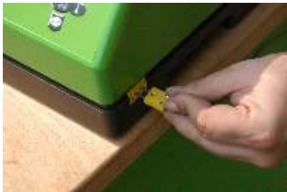
1. Verbinden Sie den magnetischen Temperaturfühler mit dem T-AW-20.
