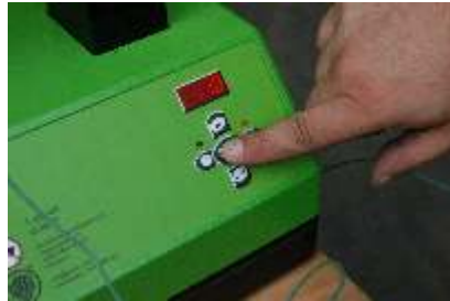
8. Sobald die eingestellte Temperatur erreicht ist ertönt ein Signalton. Drücken Sie nun nochmals die "start/stop" Taste.
