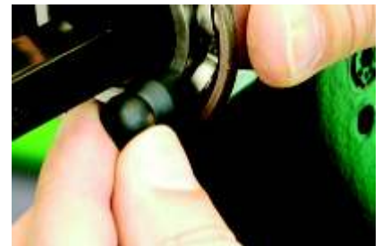
6. Bringen Sie nun den Magnetsensor so dicht und mittig wie möglich am Innenring an.
