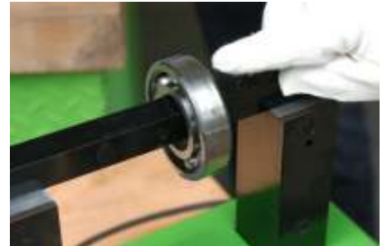
9. Kugellager von der Leiste nehmen. WICHTIG! Isolierte Handschuhe verwenden. VERBRENNUNGSGEFAHR!
