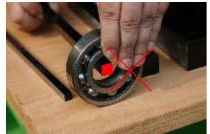
3. Wählen Sie die größtmögliche Leiste für das zu erwärmende Teil aus.
