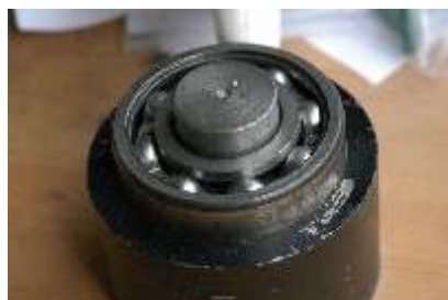
11. Das Kugellager kann nun auf die Welle gesetzt werden.
