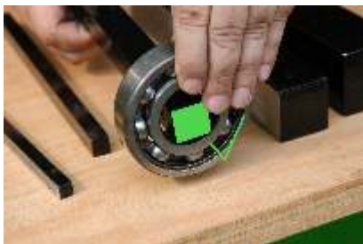
4. Die nicht lackierte Seite ist immer korrosionsfrei, damit der Strom ungehindert fließen kann.
