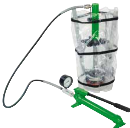
Hydraulische Werkstattpresse im Einsatz mit Unfallschutz-Abdeckplane Art.Nr. UFP-2. Die Unfallschutz-Abdeckplane umschließt den Arbeitsbereich. Der Arbeitsvorgang kann von Anfang bis Ende beobachtet und kontrolliert werden.
