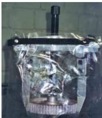
Mechanischer 3-Arm-Abzieher im Einsatz mit Unfallschutz-Abdeckplane Art.Nr. UFP-1. Abzieher und Werkstück sind während des Abziehvorganges sicht- und kontrollierbar.
