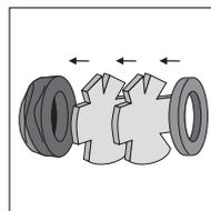
Dichtkissen und Kapselpolster können durch das Hygiene-Set ausgetauscht werden.
