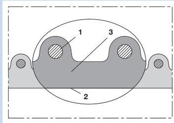
Saugfahrzeugschlauch, superschwer und extrem verstärkt
