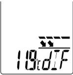
Denne modus relaterer til den infrarøde temperatur og beregner differensen mellem maksimal og minimal infrarød temperatur for en igangværende måling. Ved start af en ny måling, eller hvis man trykker på udløseren (9), slettes og genberegnes værdien.
