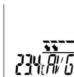
Die Modi Max/Min/AVG beziehen sich auf die Infrarot-Temperatur und zeigen jeweils die Maximal-, Minimal- oder Durchschnitts-Infrarot-Temperatur an. Die Max/Min/AVG-Werte werden während der laufenden Messung bei gedrücktem Auslöser (9) ermittelt. Bei Start einer neuen Messung bzw. durch Drücken des Auslösers (9) wird der Wert gelöscht und neu berechnet.
