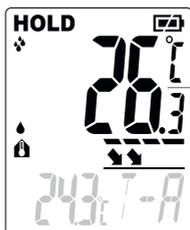
Anzeige der Infrarot-Temperatur (in jedem Messmodus)
