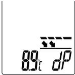
La temperatura del punto de condensación es la temperatura que se debe superar para que el aire pueda generar vapor de agua en forma de gotas, niebla o rocío. La humedad por condensación se crea, por ejemplo, cuando una pared interior o intradós de ventana tiene una temperatura inferior a la temperatura de punto de condensación de la estancia. Entonces, se crea humedad y medio de cultivo para hongos y daños materiales.
