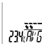
Les modes max./min./moy. se basent sur la température infrarouge et indiquent respectivement la température par infrarouge maximale, minimale ou moyenne. Les valeurs max./min./moy. sont calculées pendant la mesure en cours lorsque l'on appuie sur la touche de déclenchement (9). La valeur est supprimée et à nouveau calculée lorsqu'une nouvelle mesure est lancée ou en appuyant sur la touche de déclenchement (9).
