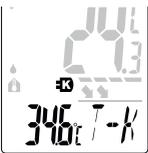
Het toestel schakelt automatisch naar de contacttemperatuurmodus T-K zodra een temperatuursensor (K-type) wordt aangesloten. Terwijl de temperatuursensor is aangesloten, schakelt het toestel bij een batterijlading van minimaal 15% niet automatisch uit.
