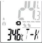
L'appareil passe automatiquement au mode de température par contact T-K dès qu'une sonde de température (type K) est connectée. Si la sonde de température est connectée, l'appareil ne s'éteint pas automatiquement lorsque l'accu est chargé à au moins 15%.
