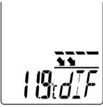
Ce mode se base sur la température par infrarouge et calcule la différence entre la température par infrarouge maximale et la température par infrarouge minimale d'une mesure en cours. La valeur est supprimée et à nouveau calculée lorsqu'une nouvelle mesure est lancée ou en appuyant sur la touche de déclenchement (9).
