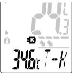
Apparatet skifter automatisk til kontakt-temperaturmodus T-K, så snart der tilsluttes en temperaturføler (K-type). Når temperaturføleren er tilsluttet, slukker apparatet ikke automatisk, hvis batteriladningen er mindst 15%.
