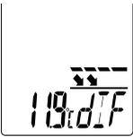
Dieser Modus bezieht sich auf die Infrarot-Temperatur und berechnet die Differenz der maximalen zur minimalen Infrarot-Temperatur einer laufenden Messung. Bei Start einer neuen Messung bzw. durch Drücken des Auslösers (9) wird der Wert gelöscht und neu berechnet.
