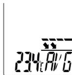
Los modos Max/Min/AVG hacen referencia a la temperatura por infrarrojos e indican la temperatura máxima, mínima y media respectivamente. Los valores de máxima, mínima y media se calculan durante la medición con el botón de activación (9) pulsado. Al inicio de una nueva medición, o al pulsar la activación (9), se borra el valor y se calcula de nuevo.
